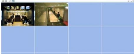
Mit VMD (Video Motion Detection) wird bei einem Ereignis das Livebild der jeweiligen Kamera auf einer Popup-Anzeige eingeblendet. Bis zu zwei separate Monitore können für die Popup-Anzeige verwendet werden.
